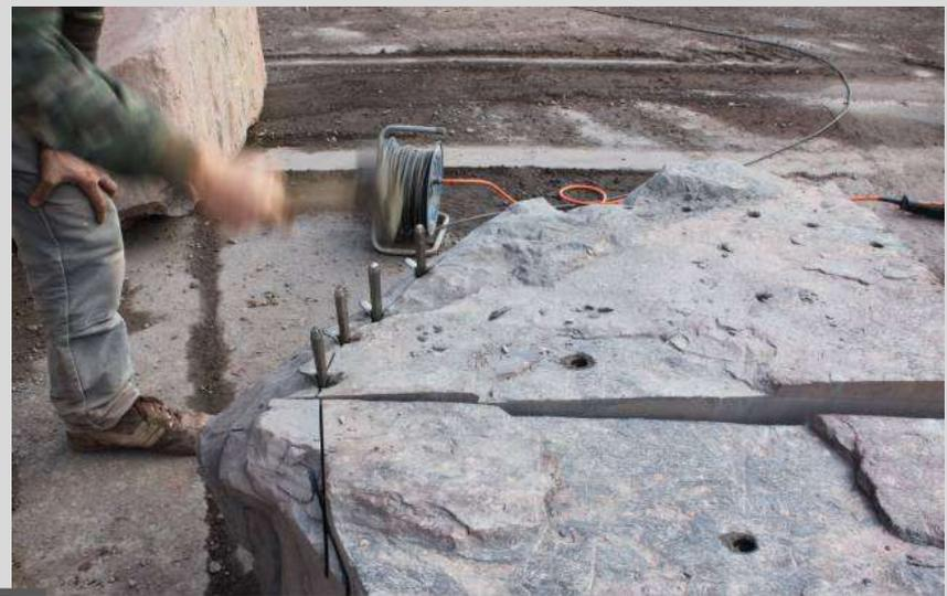
Keile in die Bohrlöcher treiben und die Steinstücke werden abgeschlagen
